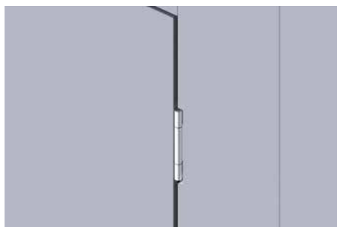
Nastavitelné 3D závěsy z ušlechtilé oceli
