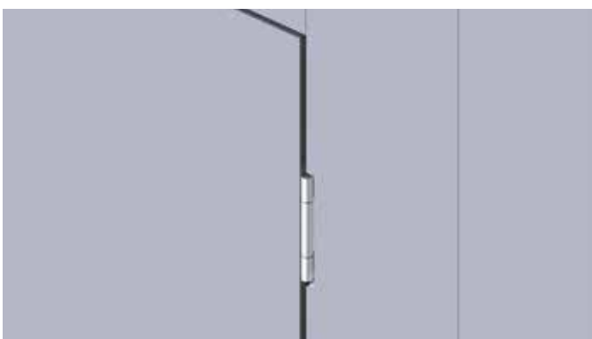
Závěsy nastavitelné ve 3 rovinách z ušlechtilé oceli
